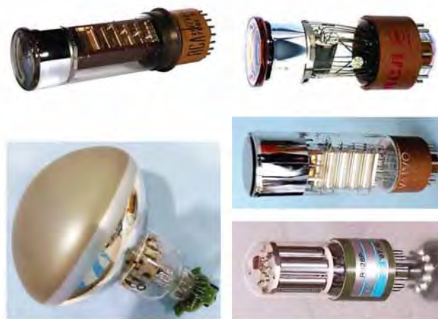
شکل (۲-۱۱) تیوب‌های تکثیرکننده فوتونی در ابعاد و شکل‌های متفاوت.
