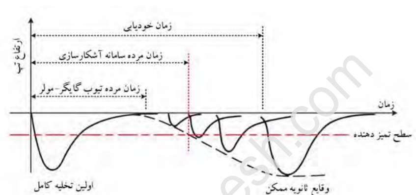
شکل (۲۷-۲) پالس‌های متوالی و با دامنه منفی و اثر زمان مرده در آشکارساز گایگرمولر.
